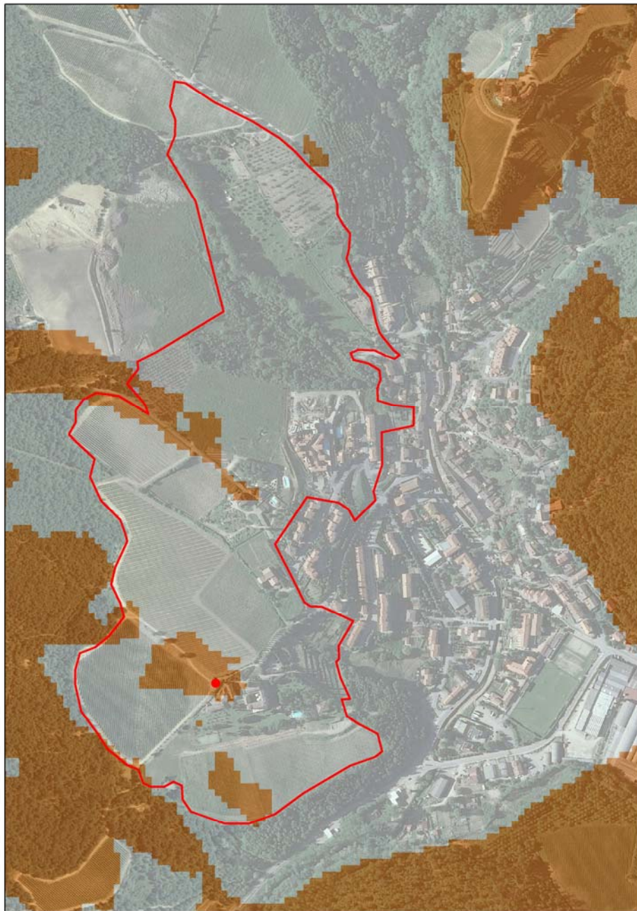
Figura 7 – Inquadramento dell'area di pertinenza del B.S.A. su volo aereo 2010: analisi dell'intervisibilità (le aree visibili sono di colore arancione, mentre le aree non visibili sono le opache bianche, il punto rosso è il punto di osservazione ad altezza umana), scala originale 1:5.000.
